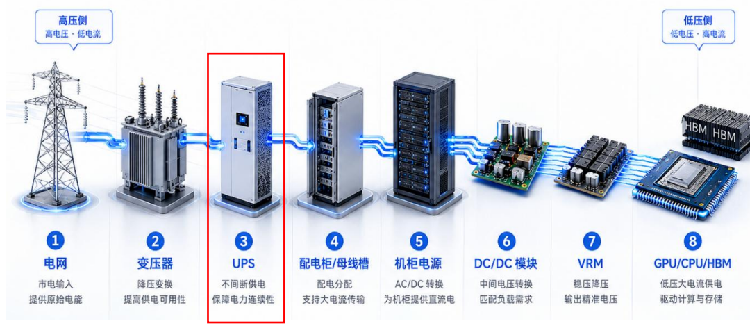
图20: 数据中心电力设备架构示意图
