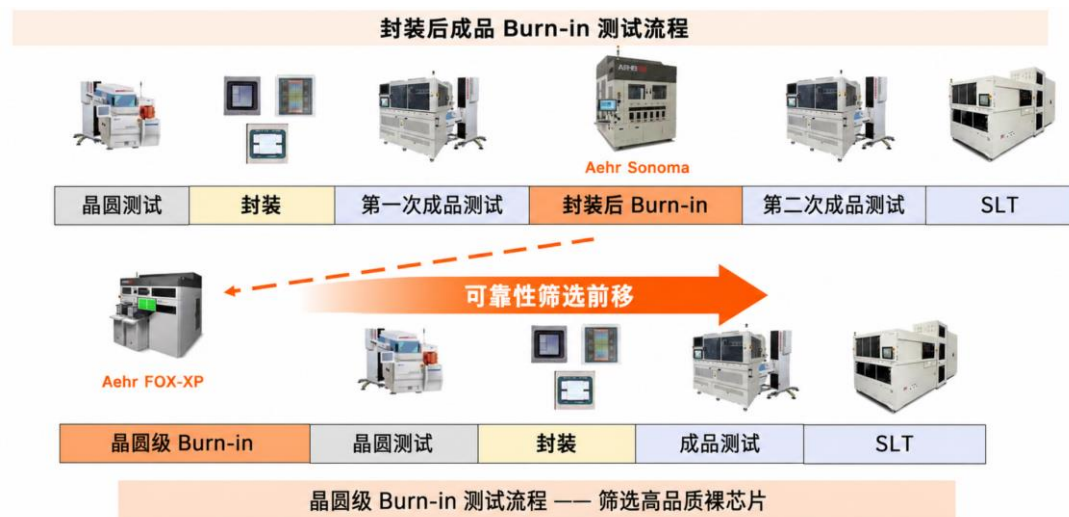
图表5: Burn-in 通过高温高压测试，提高芯片可靠性
