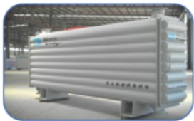
污水及地表水前置取热装备
