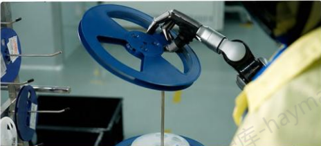
高精度对齐挂载料盘，自动读取信息并完成绑定
