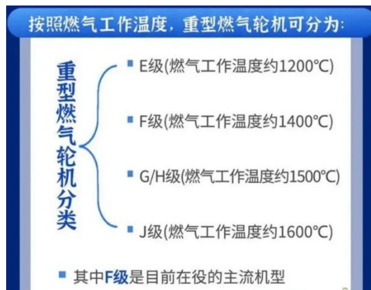
图表10：按照燃气温度，重型燃气轮机可分为 E、F、G、H、J 级
