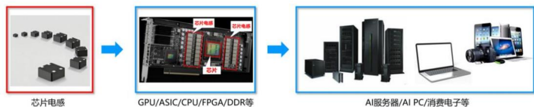
图表 23：芯片电感起到为 GPU、ASIC、DDR、FPGA、CPU 等芯片前端供电的作用
