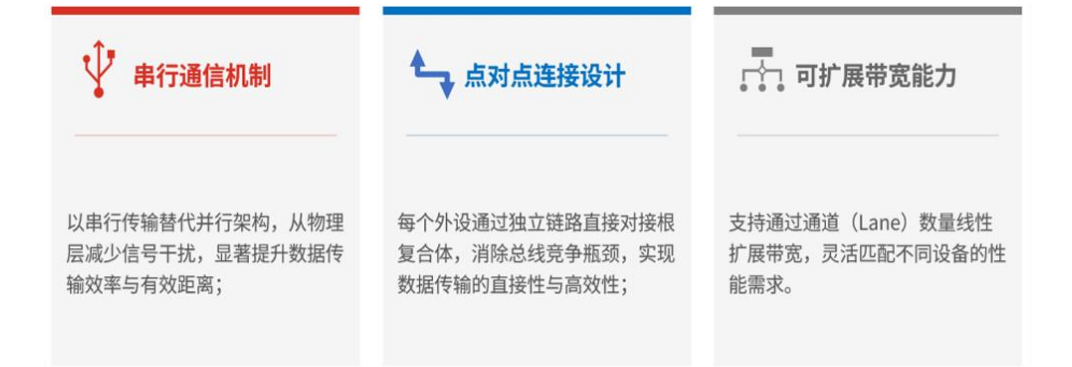
图1: PCIe 协议具备串行通信机制、点对点连接设计及可扩展带宽能力三大核心特性
