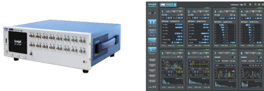
图35：公司误码分析仪设备及实时监控示意图
