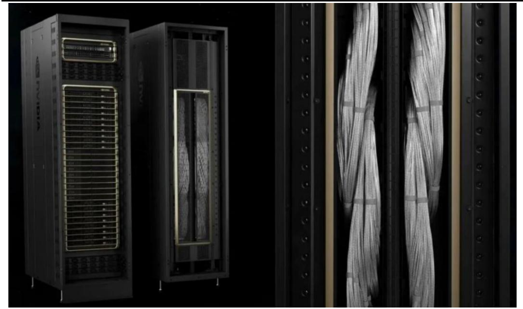
图11: 英伟达 GB200 内部使用铜连接
