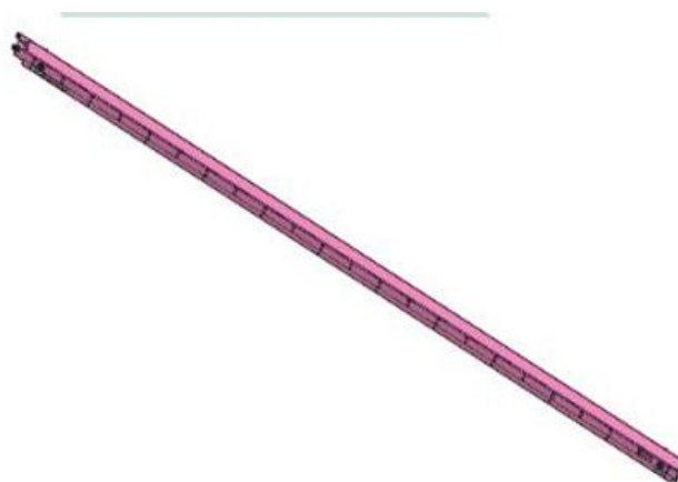
图18: 采用 Busbar 为各节点提供电源
