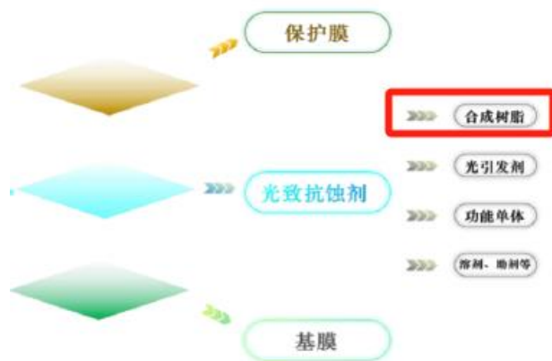
图表26：光致抗蚀剂是感光干膜的主体和核心
