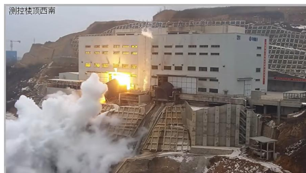
图 32：航天六院 240 吨级液氧煤油发动机长程试车
