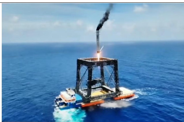
图 28：长征十号乙成功实现网系回收
