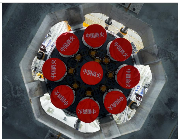
图 31：长征十二号乙一级并联 9 台 YF-102R
