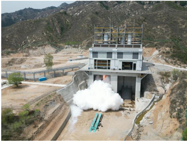
图 33：航天六院 140 吨级液氧甲烷发动机试车
