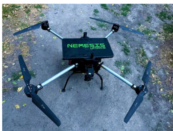
图 21：集成了 Starlink 卫星通信终端的乌克兰轰炸无人机 Nemesis
