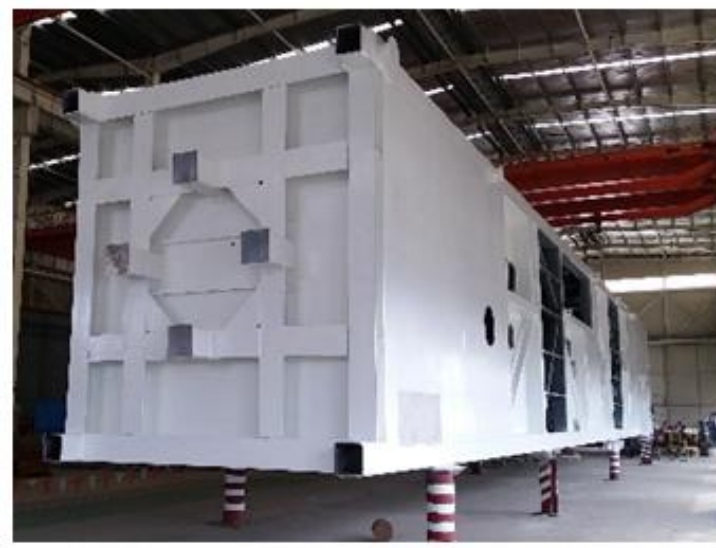
液空波兰冷箱主冷模块
