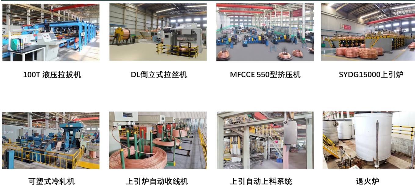
图表27：公司具备覆盖铜排主要生产环节的制造装备
