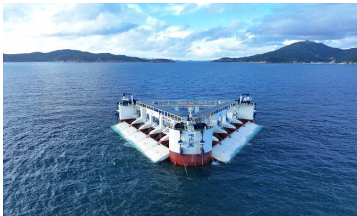
图 世界首台兆瓦级漂浮式波浪能发电装置“南鲲”号
