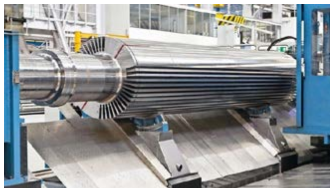
要加工长度达16米、直径大于1米的发电机轴，需要专用机床和专用刀具。
