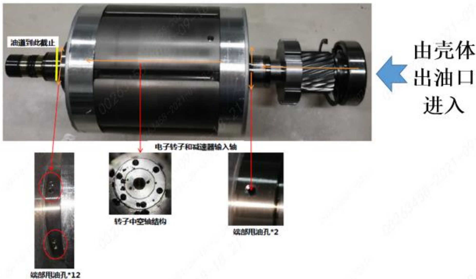
图19 油道冷却回路示意图
