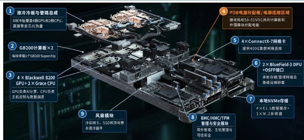
图表 20：柜内取消 power shelf (PSU)，在 PDB 电源板将 800V 直降 12V
