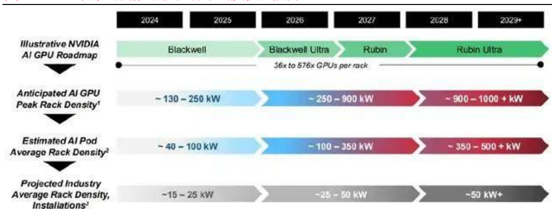
图 1：GPU 技术迭代推动机柜功率密度快速提升
