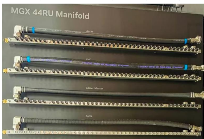
图20: 英伟达 MGX 44RU 机架通用标准液冷歧管
