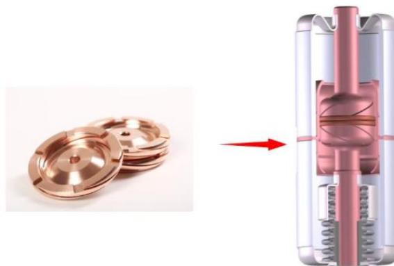
图 26：真空灭弧室示意图
