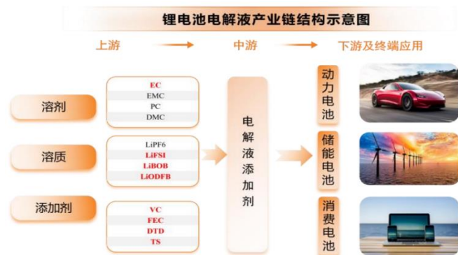
图16：锂电池电解液产业链结构示意图
