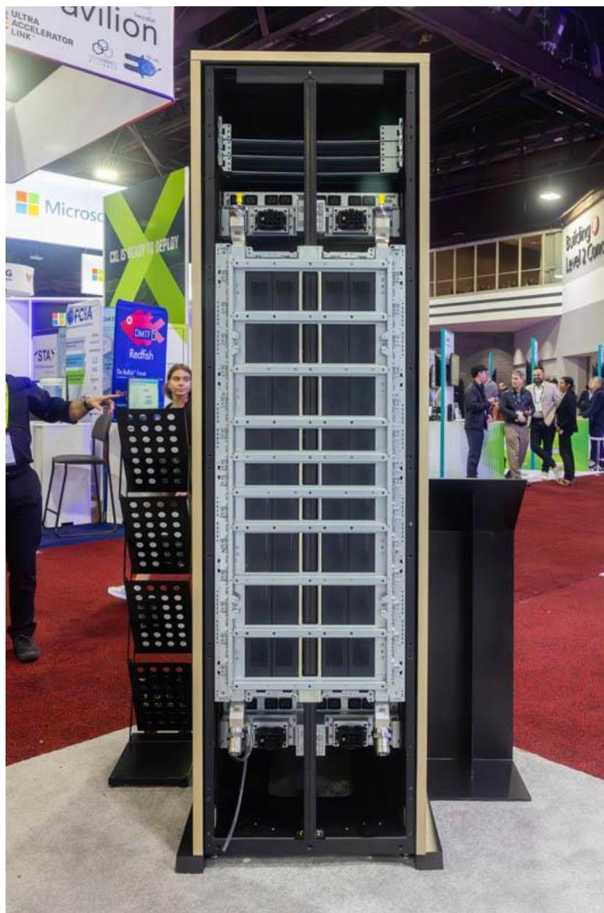
图表7: NVIDIA Rubin NVL576 机架取消了连接 NV Link 交换机和计算刀片的线缆卡带
