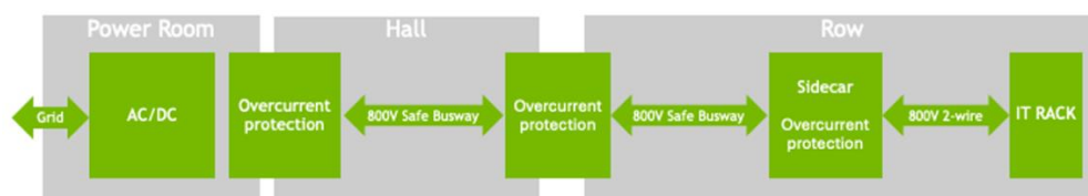
图表21：下一阶段 AI 数据中心将采用的 800VDC 电源架构
