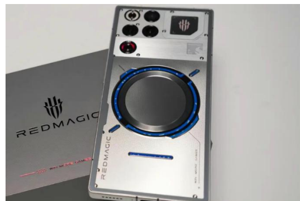
图 13：红魔 11 pro+ 采用微泵液冷方案
