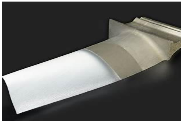
图表33：YSZ 悬浮液喷涂制备热障涂层
