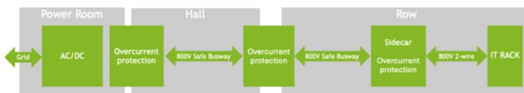
图 3: Kyber 采用 800VDC 高压直流供电架构
