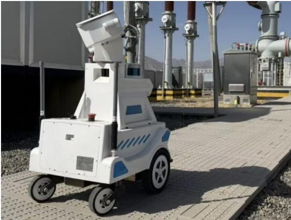
图 38: 武威光晟电站巡检机器人
