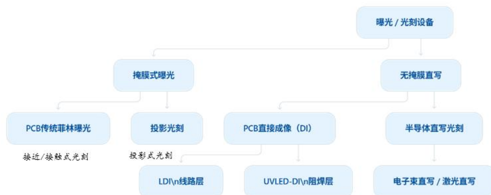
图表23: 光刻技术分为掩膜式曝光和无掩膜直写
