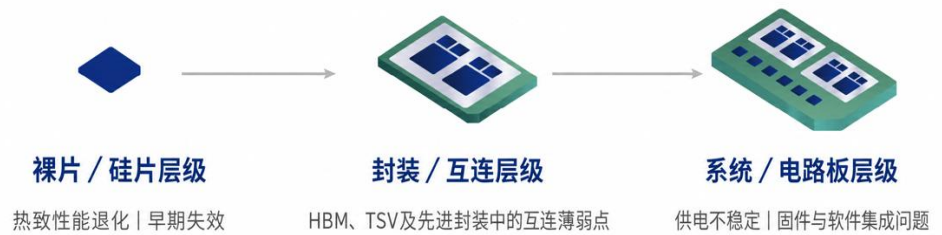
图38: SLT 可识别多层次系统故障，提升真实应用场景测试覆盖
