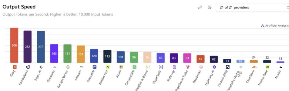
图7：LPU 的输出速度业内领先（测试基准为 Llama 3.3 Instruct 70B）
