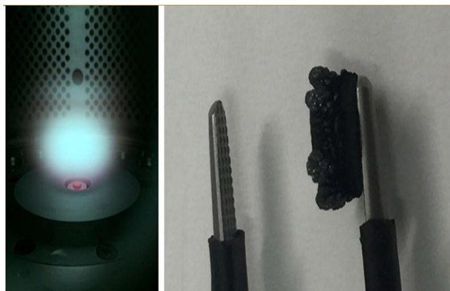
图 26：CVD 金刚石晶体生长及出炉形态
