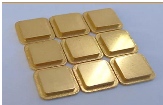
图 43：表面镀膜后的金刚石-铜复合材料导热基板
