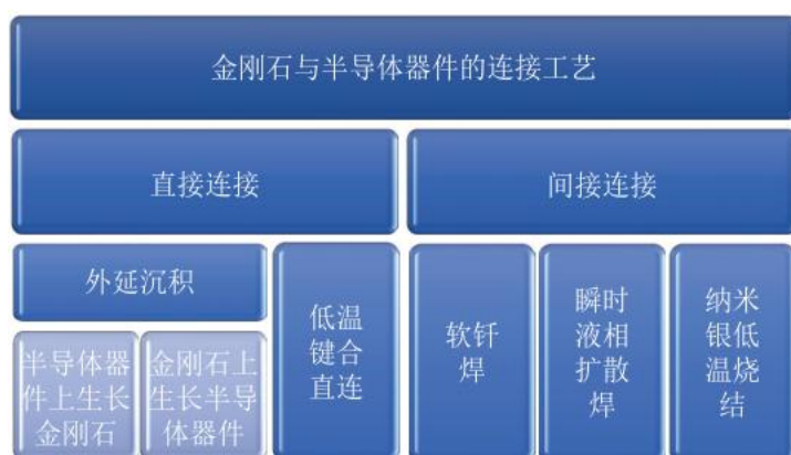
图 36：现有金刚石与半导体器件连接工艺的技术路线图
