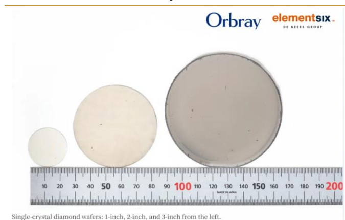
图 74: Element Six 与 Orbray 单晶金刚石晶圆已拓展至 3 英寸
