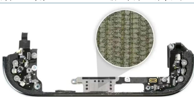
图表71：苹果 iPhoneAirUSB-C 接口采用 3D 打印技术
