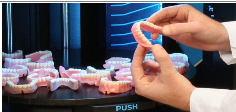
图表42：使用 Stratasys J5 DentaJet 一次性打印多口假牙
