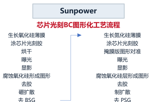
图表 37：Sunpower 的芯片光刻 BC 技术路线
