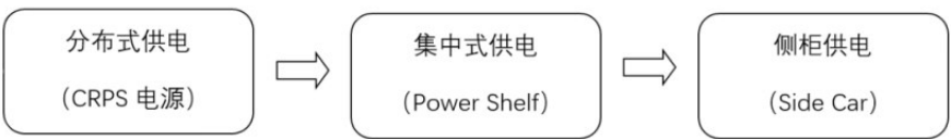
图37 数据中心柜内供电部件规格演进
