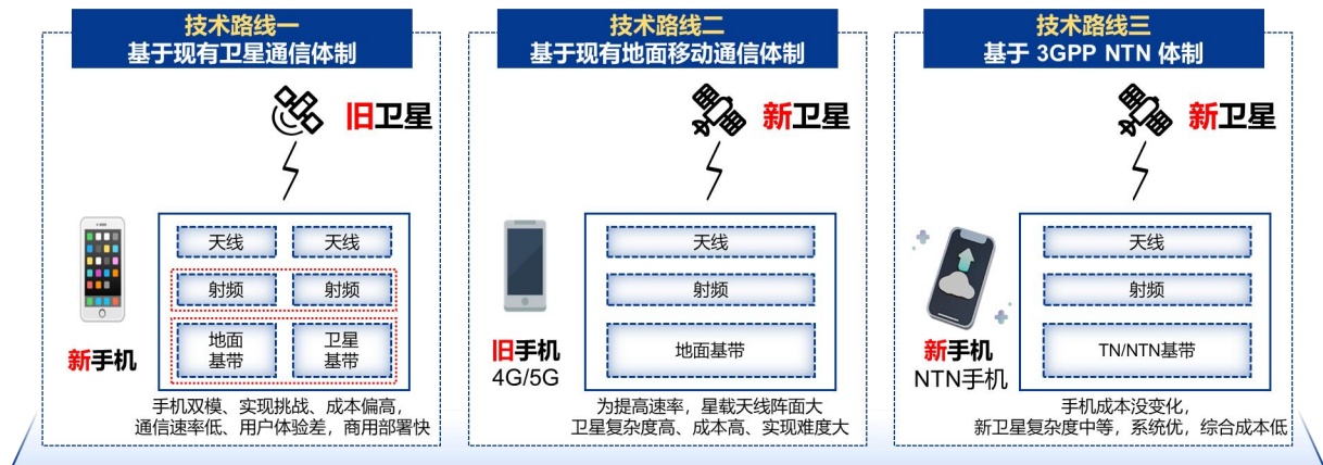
图 1 手机直连卫星的三种技术路线
