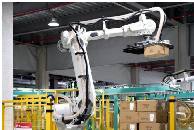
图28：珀莱雅智能工厂的拆垛机器人
