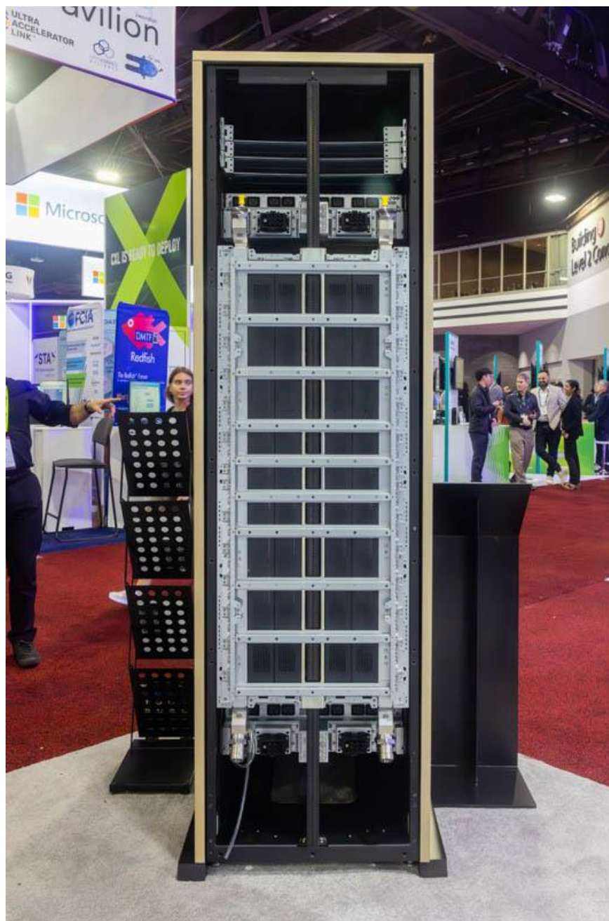
图表8: NVIDIA Rubin NVL576 机架取消了连接 NV Link 交换机和计算刀片的线缆卡带
