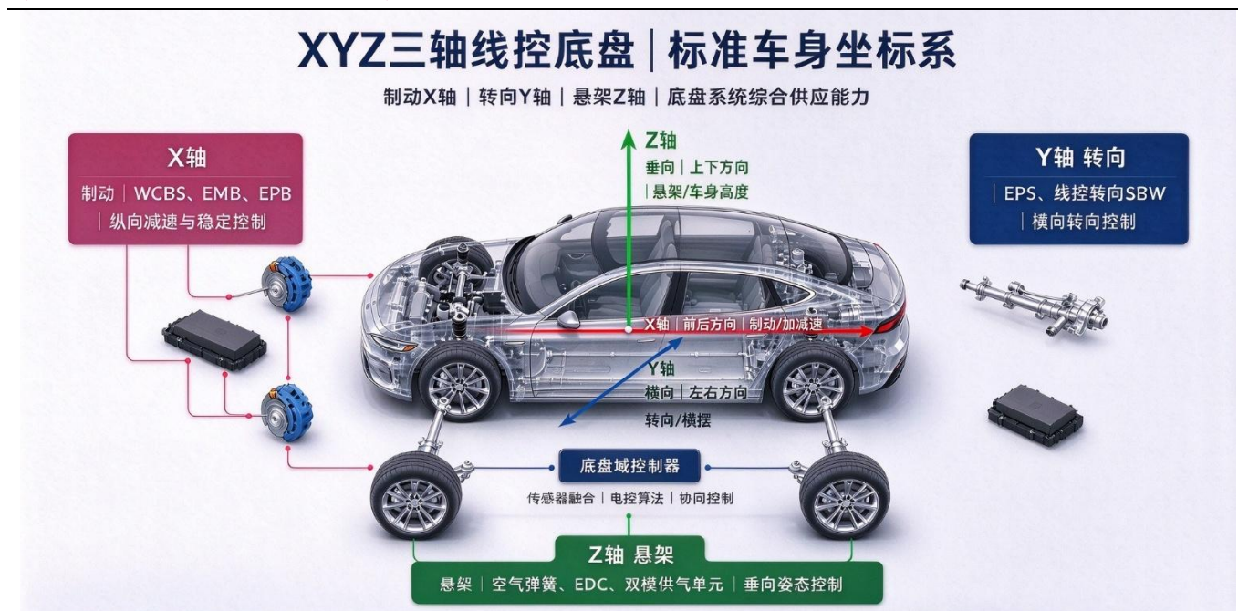
图表 45: XYZ 三轴线控底盘示意图
