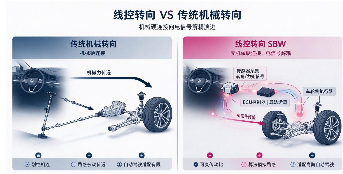
图表 43：线控转向取消刚性连杆，转向动作由电控系统精确分配
