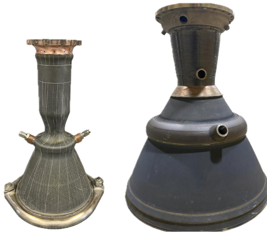
RAMPT 项目复合材料包覆燃烧室与增材制造喷管
