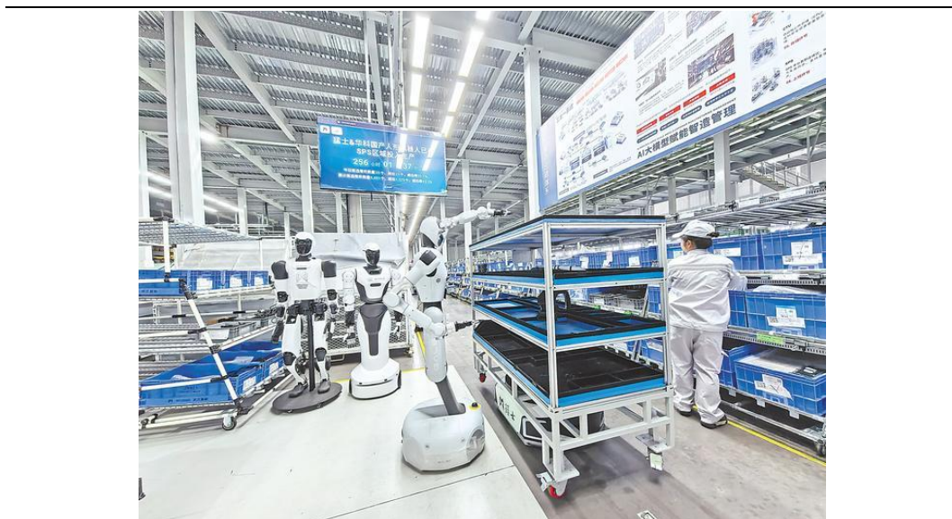
图表 3：机器人用于东风猛士汽车车间物料搬运
