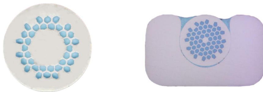
图 19：西部超导 NbTi 超导线材示意图
