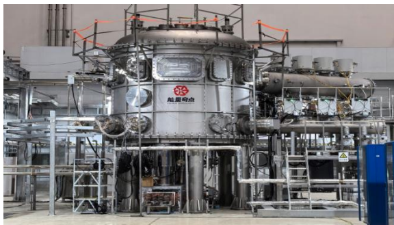
图 25：能量奇点全球首台全高温超导托卡马克装置示意图 图 26：能量奇点经天磁体示意图
