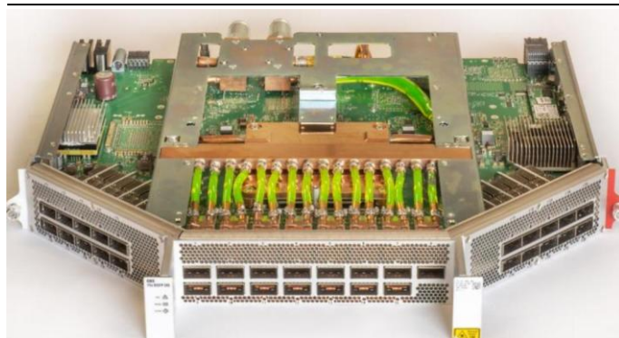
图14: Ciena 采用软管连接光模块冷板
