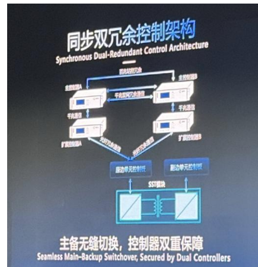
图：四方股份数智1.0 SST控制架构设计
