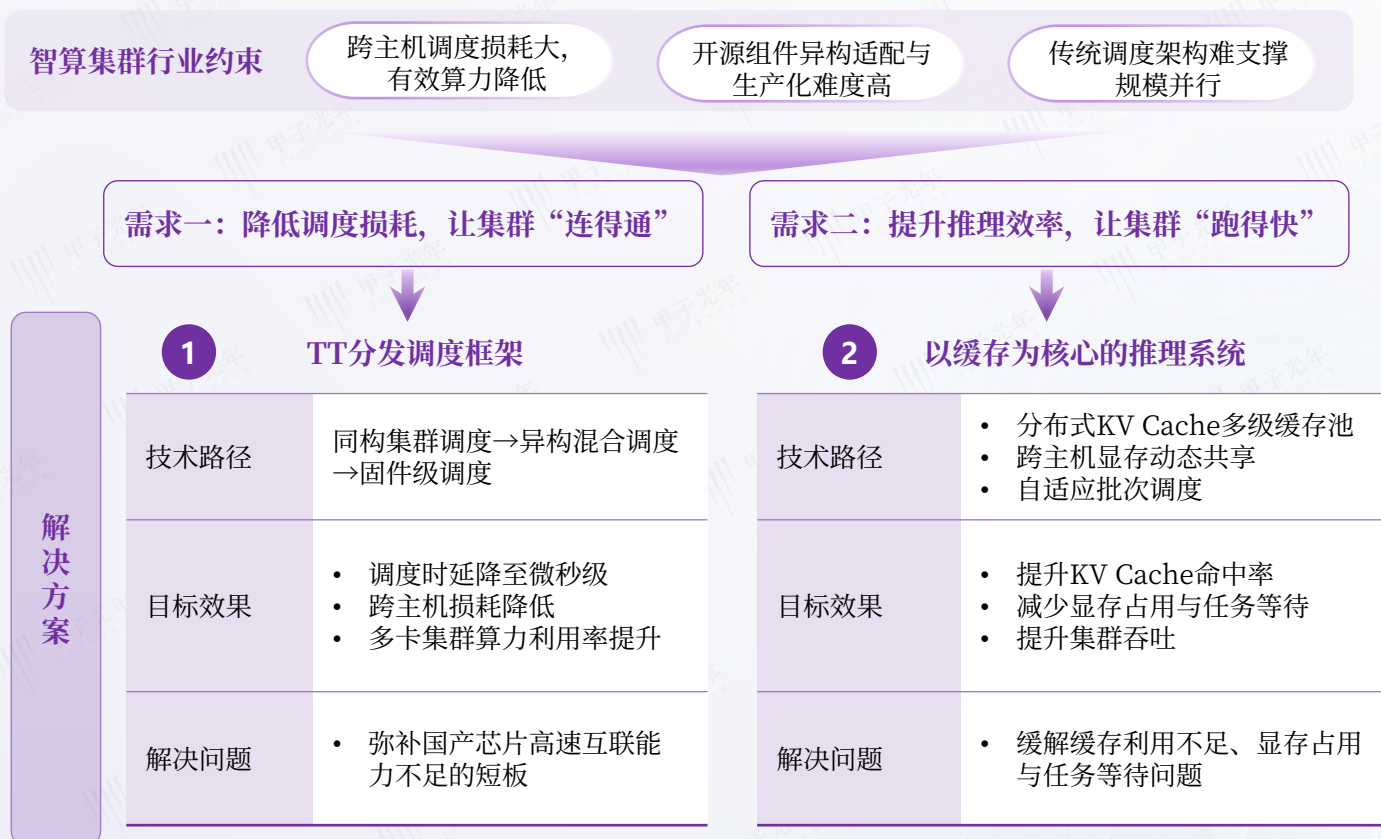
图20：蓝耘科技·AI Infra OS L1-L2层调度框架+推理引擎集群效率优化方案
