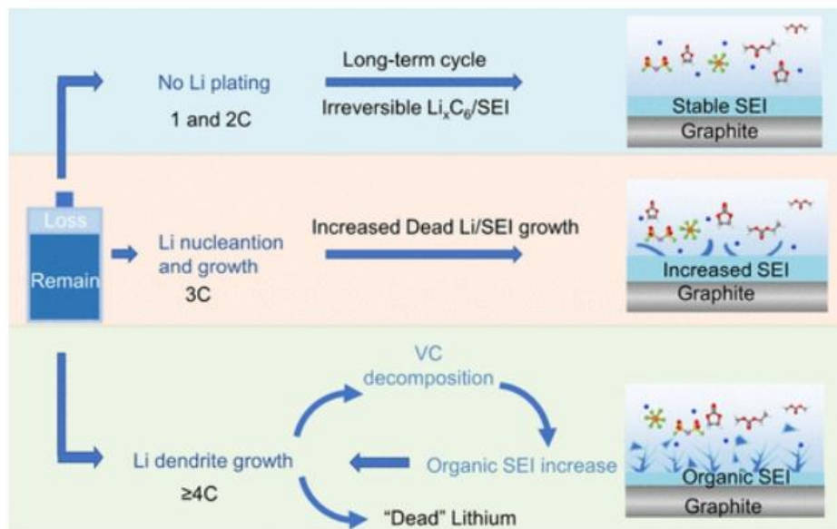
不同充电速率下电池老化机理示意图
