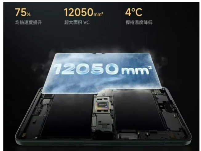
图16：REDMI K Pad 采用领益超大面积铝基 VC 方案
