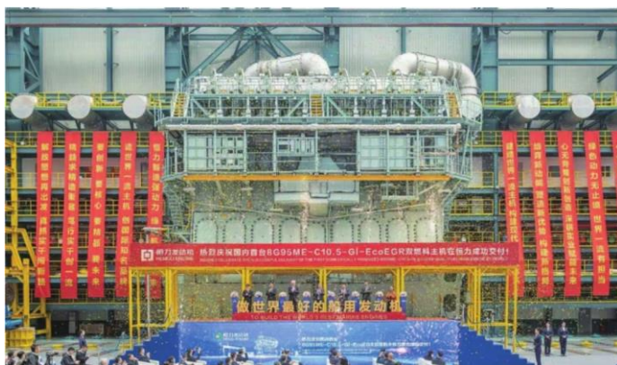
图表75：公司首台8G95 LNG双燃料发动机
