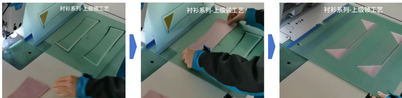
图表101：模板机自动化程度更高，但上下料还是需要人工操作
