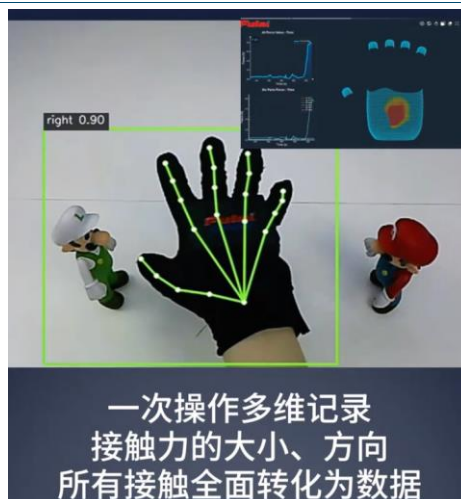
图表8：数采手套采集触觉数据示意图
