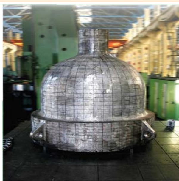
中国一重是中国核电设备先行者，肩负核电设备国产化的历史重任，在核岛设备的主要部件中，除主泵不属于公司的产品领域外，其他重要的大型部件如反应堆压力容器，蒸发器、稳压器、主管道、主泵泵壳及核堆内构件，中国一重均已能够制造，中国一重是国内唯一能提供全套核电大型铸锻件的企业，是国内唯一既具有大型核电锻件又具有核岛成套设备制造能力的企业，掌握2+及3代核电大型锻件铸造技术。在核电压力和核电大型铸锻件国内市场占有率80%以上。
