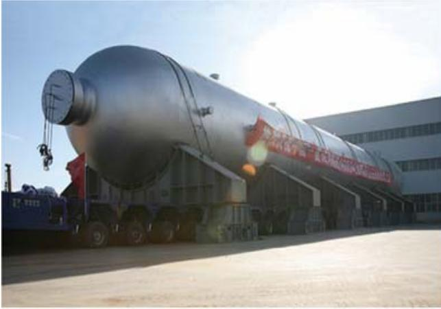
图表 24、中国一重 2044 吨煤液化反应器
