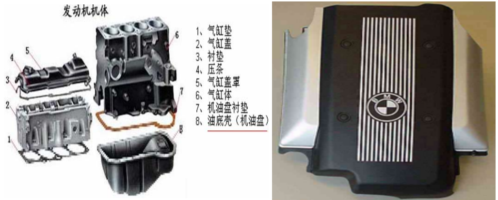
图 8、发动机机体构造及油底壳位置示意图/玻璃纤维复合材料气门室盖
